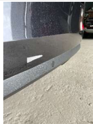
Царапины на заднем бампере
