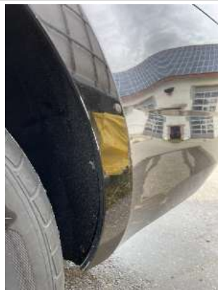
Царапины на заднем бампере
